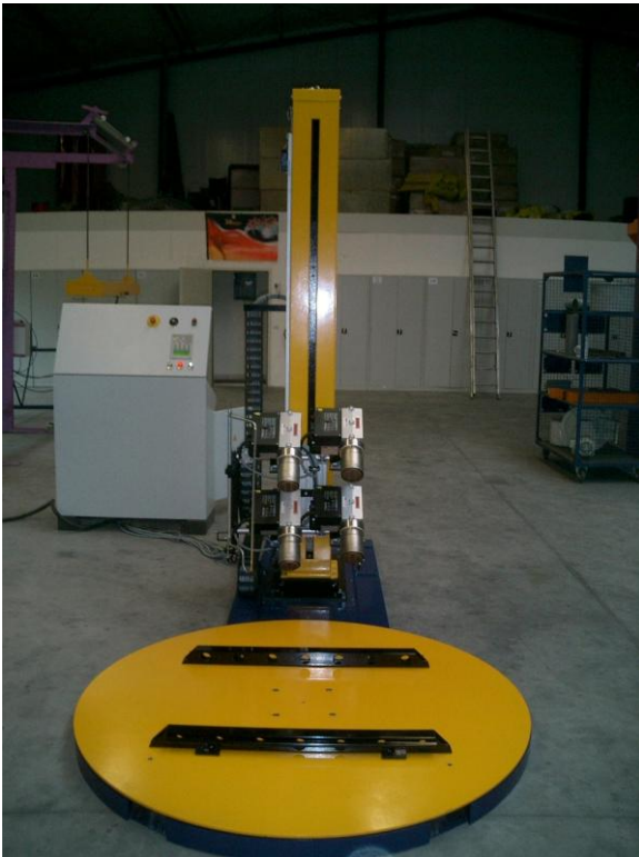
Abbildung zeigt den SchrumpfLIFT elektrisch Mit 4 Heißluftstrahlern
